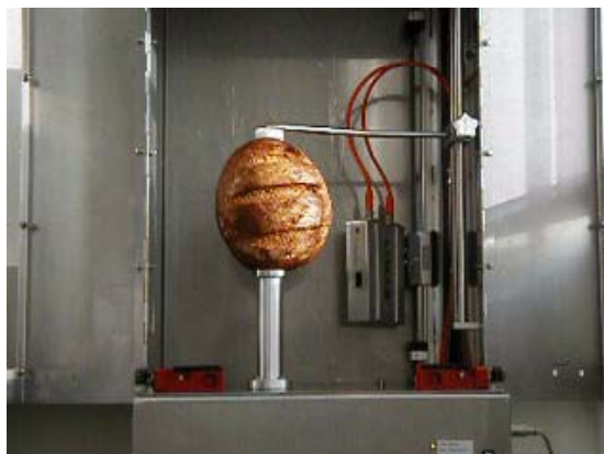
Abbildung: Brotvolumenmessung mittels BreadVolScan
