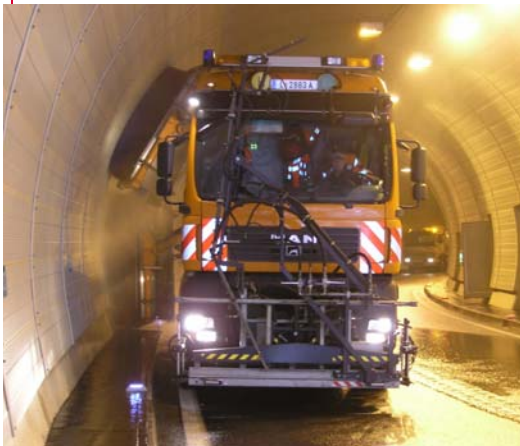
Abbildung: Tunnelwaschfahrzeug im Einsatz
